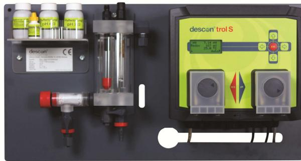
Mess- und Regelgerät descon®trol S CHLORFREI / pH / t - Aktivsauerstoffdosierung OxiActiv zeitgesteuert - mit 2 descon dos E - Schrittmotor-Dosierpumpen, mit verschleißfreiem Schrittmotor, Dosierleistung max. ca. 5 l/h. Kompaktmesszelle 0310/R inkl. Messwasserüberwachung, Messwasserentnahmehahn, Faserfilter mit integriertem Kugelhahn (gesamte Armatur leicht reinigbar)
